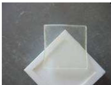
Figure 3 Film de polyuréthane irradié sous UV pendant 60 min
