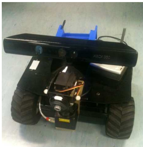
Figure 6 : Le robot Thumblar embarquant une Kinect.
