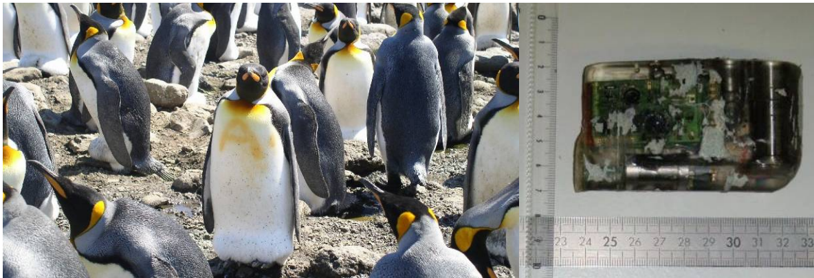
Figure II.4. Manchot royal marqué à l'acide picrique pour être repéré facilement au milieu de la colonie. À droite, un enregistreur (comportant des capteurs de pression, température et luminosité, ainsi que trois accéléromètres) récupéré sur un manchot royal de retour à terre après un voyage alimentaire.
