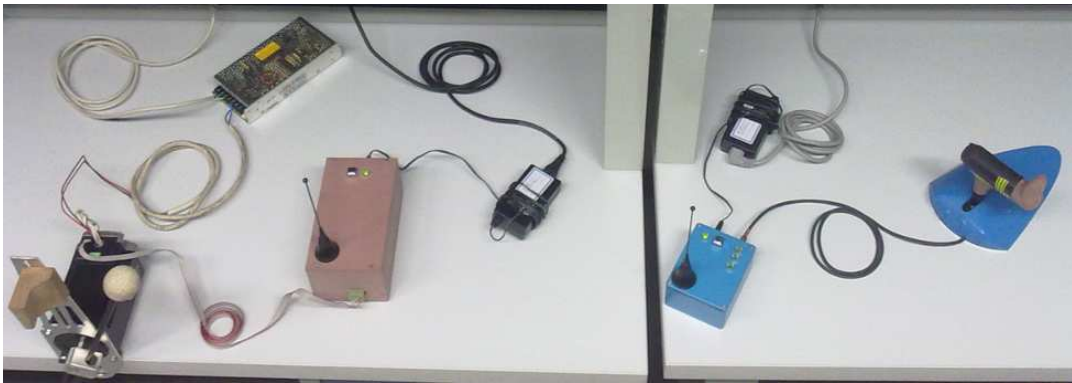
Figure 4. Système complet: à droite, le joystick et l'émetteur, à gauche, le récepteur et le moteur pas à pas rotatif auquel est fixé la mailloche.
