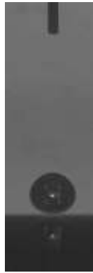
FIG. 4.2 – Vue d’ensemble du dispositif de génération d’une goutte par l’intermédiaire d’une aiguille creuse (en haut) et du plan d’impact (en bas) de la goutte. La goutte se trouve prise en photographie moins de 1 ms avant l’impact.
