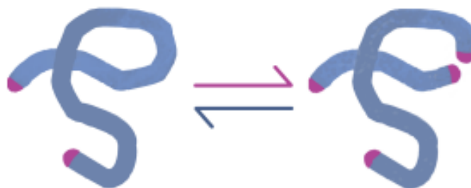
FIG. 5.7 – Illustration du phénomène de coupure-recombinaison réversible des micelles allongées et flexibles.
