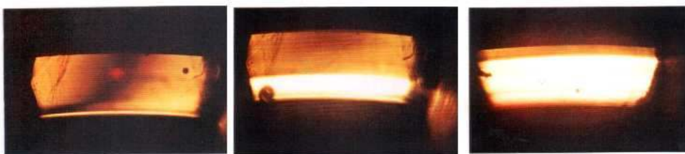
FIG. 5.12 – Observation en biréfringence d’une solution de CTAB - D_2O isotrope au repos. Les photographies de gauche à droite correspondent aux gradients de vitesses imposés de début, de milieu et de fin de plateau de la courbe de contrainte en fonction du gradient de vitesses du CTAB - D_2O (la courbe n’est pas montrée ici mais est similaire à la courbe de la figure 6.10 (Cappelaere et al. [1997])).
