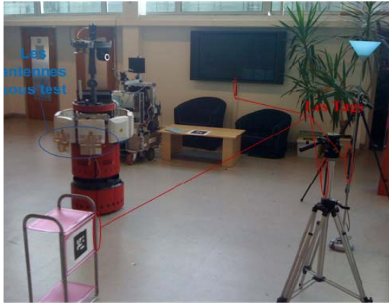
Figure 8. Configuration de la validation des antennes réalisées.
