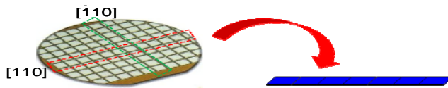
Figure 11 – Lamelles IGBT obtenues à partir d'un wafer (découpes suivant les deux axes cristallographiques)
