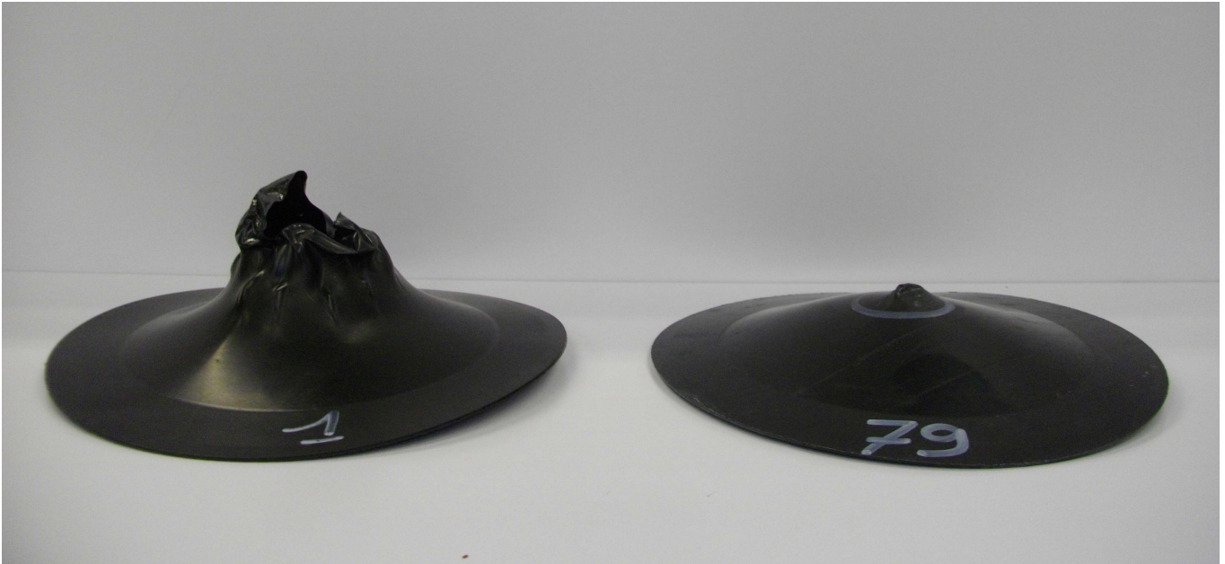
Figure 3. Aspect d'éprouvettes après essais de traction bi-axiale, à gauche pour un PEHD vierge et à droite pour un PEHD après essai d'endommagement statique
