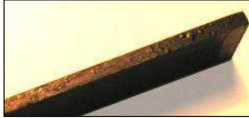
Figure 28 : Exsudation d'extraits lors du chauffage à 103°C (épaisseur de la face LT représentée ≈ 2mm).
