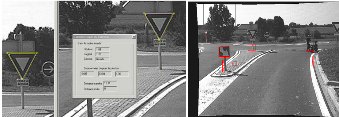
Figure 6 : Mise en correspondance d'une forme triangulaire et mesure des dimensions d'un panneau "AB3a" (à gauche). Détection d'objets verticaux par analyse de la carte de disparité (à droite).
