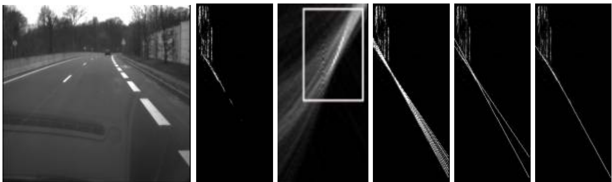
Figure 9 : Extraction du profil longitudinal de la route. De gauche à droite : une image de la paire stéréo correspondant à l'approche d'une descente, l'image I_{v\Delta} correspondante, la transformée de Hough associée (le rectangle blanc figure la zone de recherche des k plus grandes valeurs dans l'espace de Hough), le faisceau des m lignes droites générées, les deux enveloppes calculées, le profil longitudinal de la route en descente.
