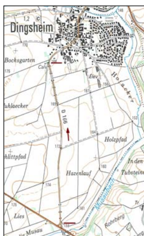
Figure 17 : Carte de l'itinéraire étudié : RD 166 (Bas-Rhin) parcouru dans le sens de la flèche, entre le carrefour du RD 41 (trait rouge horizontal du bas) et le calvaire de Dingsheim (trait horizontal du haut), (c) IGN. A droite : profil d'altitude obtenu par recalage des profils locaux. L'absence de recalage absolu entraîne une dérive par rapport au profil que l'on pourrait extraire de la carte.
