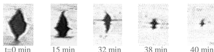
FIG. 6 – Illustration du mécanisme d'érosion. Noir N234/SBR. R_0 = 22\mu\text{m} , \dot{\gamma} = 6\text{ s}^{-1} . Mécanisme observé dans le plan écoulement/vorticité. Figure extraite de [1].
