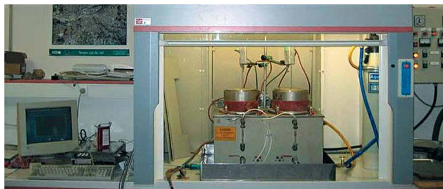
figure 2 Appareillage du test d'expansion à la vapeur.
