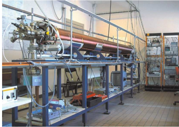
FIG. 1.5 – Le TOP de l'équipe Turbulence Plasma de l'université de Provence permet d'étudier finement l'interaction onde-particule sur une distance de 4 m.
