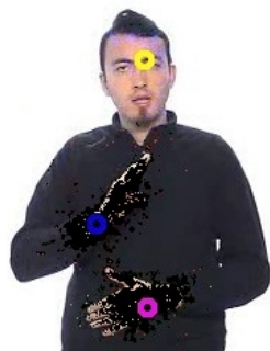
FIGURE 1 – Soustraction des nuages particulaires correspondant aux mains droite et gauche avant le suivi de la tête
