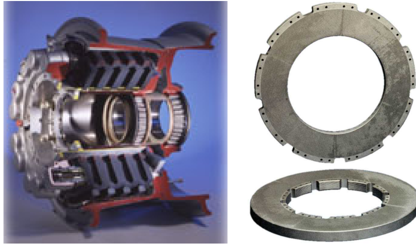
Fig. 1. Puit de chaleur type Airbus et disques de frein.
