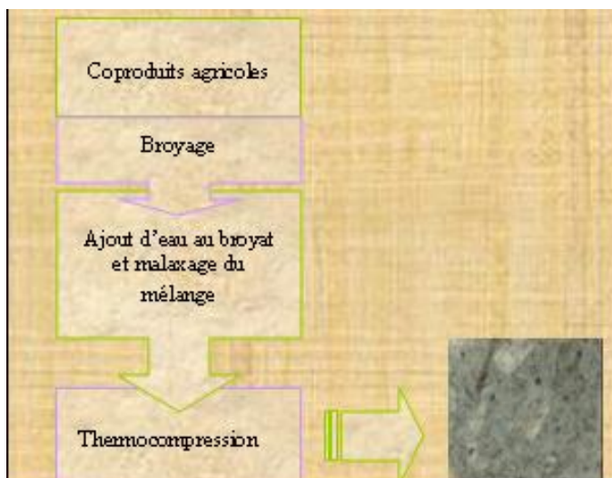
Fig.6 : Procédé de thermocompression des plaques à base d'étoupes.
