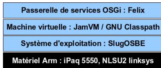
FIG. 2.6 – Pile d'exécution embarquée pour OSGi
