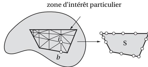
fig. 1.3 - Utilisation d'un super-élément
