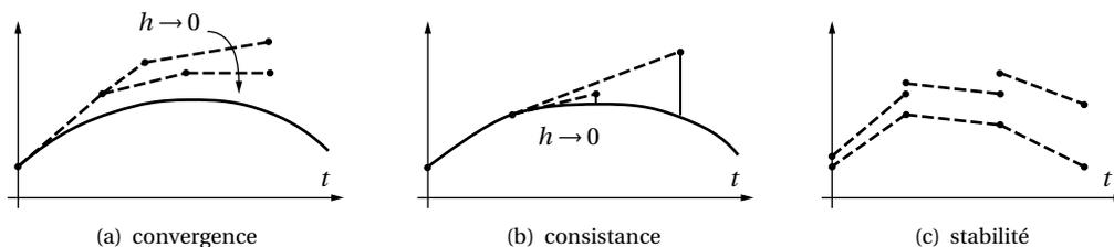
fig. 4.1 - Propriétés de base d'un schéma d'intégration
