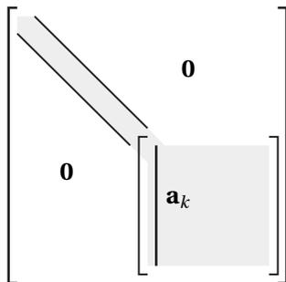
fig. 2.7 - Matrice en cours de tri-diagonalisation
