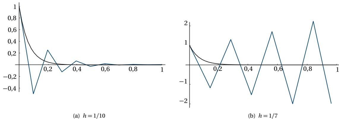
fig. 4.2 - Stabilité du schéma d'Euler explicite
