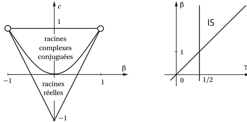
fig. 4.8 - Stabilité des schémas de Newmark
