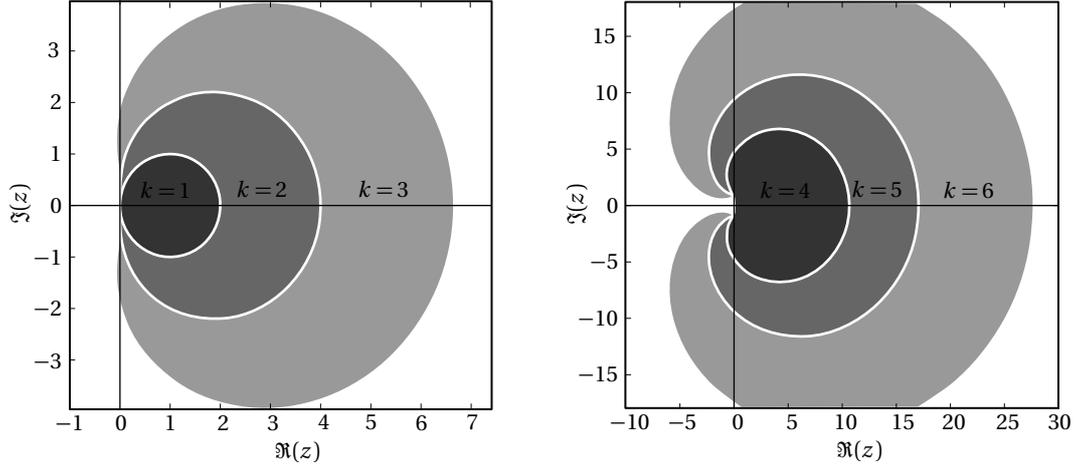
fig. 4.12 - A-stabilité dans le plan complexe pour la méthode de Gear :  $k$  est le nombre de pas
