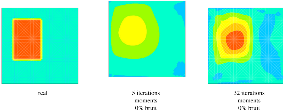
FIG. 1.6 – Identification d’une inclusion carrée en cuivre dans une matrice en aluminium, distribution réelle du coefficient de Poisson (left) et reconstruction avec bruit (milieu) et sans bruit (gauche) [Con95]
