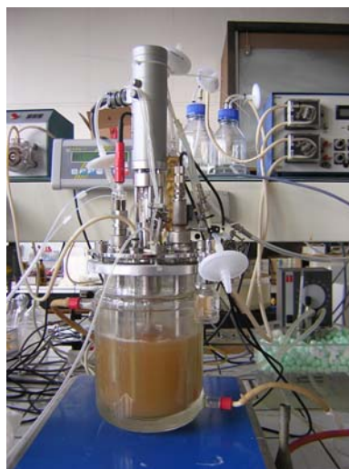
Figure A4.2. Photo du bioréacteur de culture des bactéries E. coli .
