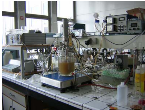
Figure A4.31. Photo du bioréacteur de culture des bactéries E. coli et les différents analyseurs utilisés.
