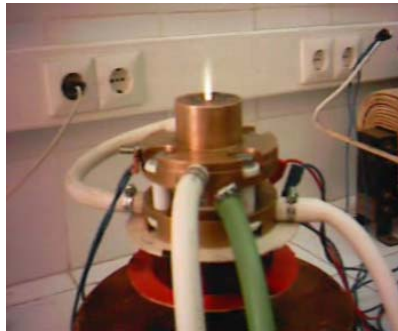
Figure 10 - Photographie du développement du jet de plasma de la torche. Le courant injecté dans la bobine est de 1 A) (la force aérodynamique du gaz plasmagène et la force électromagnétique agissent sur l'arc électrique, dans le même sens.
