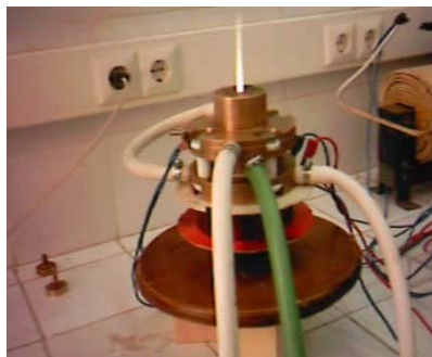
Figure 11 - Photographie du développement du jet de plasma de la torche. Le courant injecté dans la bobine est de 1 A (la force aérodynamique du gaz plasmagène et la force électromagnétique s'opposent)
