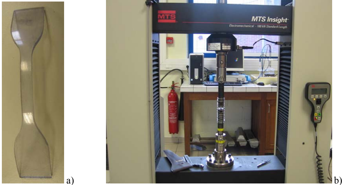
Figure 3.18 a) Eprouvette de PVC plastifié.
