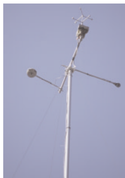
Figure 3 : Instruments de mesure installés au sommet d'un mât de 30 m.
