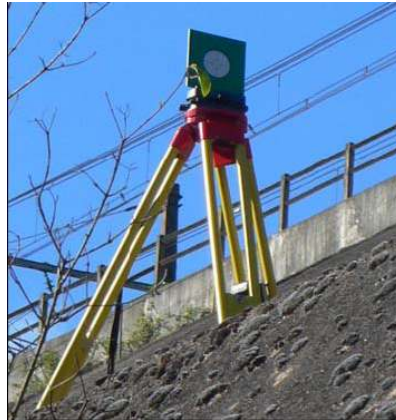
Abb. 7: Beispiel einer Zieltafel für den GX Scanner
