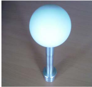
Abb. 5: Zielkugeln mit Vorrichtung zur Zwangszentrierung
