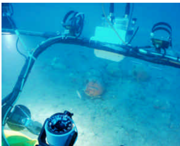
Figure 1. Vue de l'intérieur du sous-marin. L'appareil de prise de vue est situé à l'extérieur, sur la barre technique, dans le caisson étanche blanc. L'axe optique est vertical.
