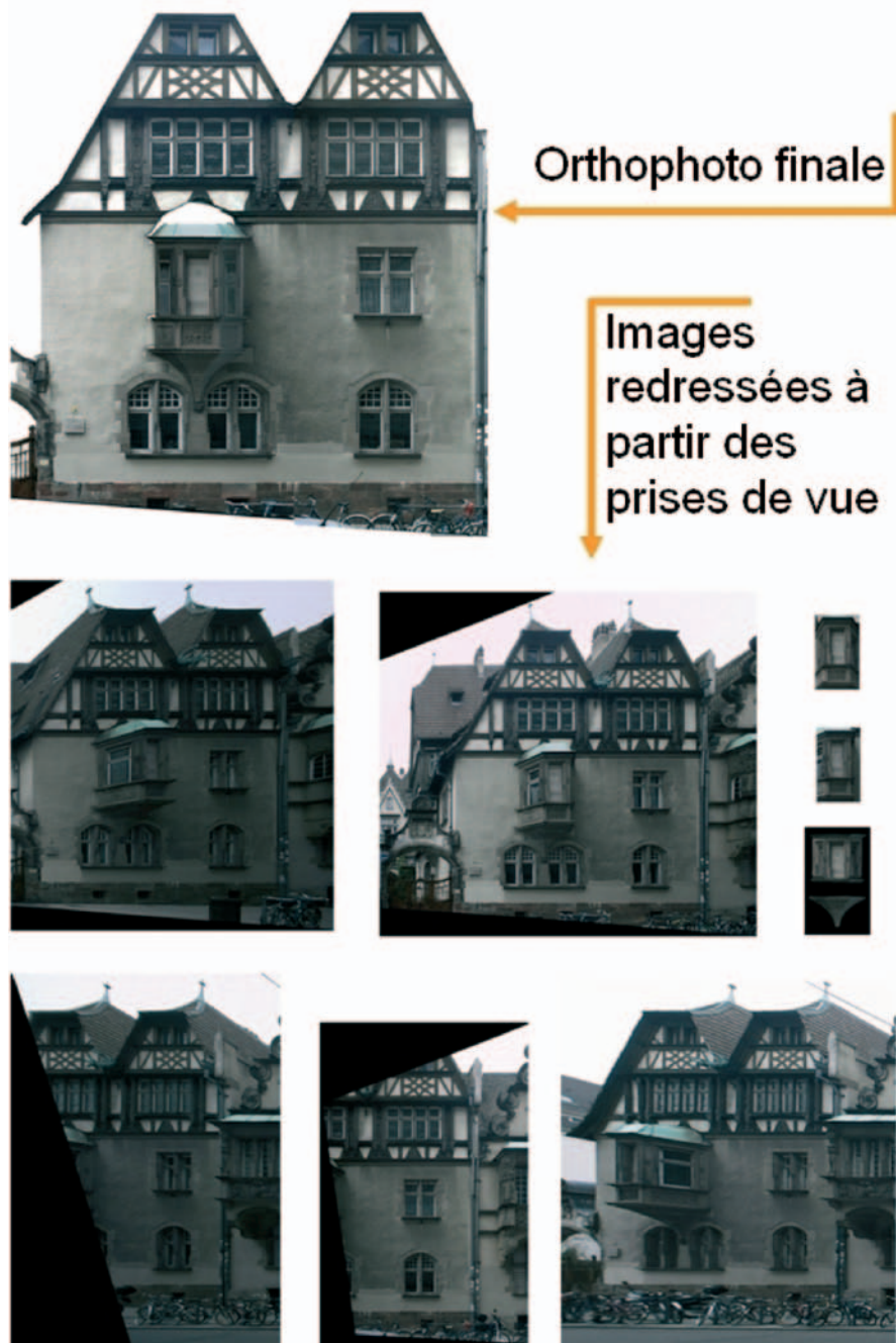
Figure 4. Orthophoto basée sur les images redressées
