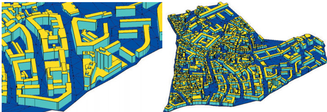
Figure 1 : Extrait de restitution d'un quartier de Strasbourg (Krutenuau) pour la constitution d'un modèle de rugosité.
