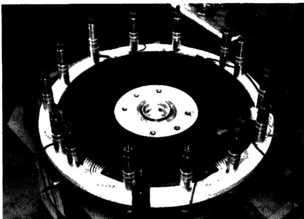
Fig. 3. — Vue des bobinages d'un des stators.
