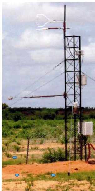
Figure 4: Vue du système EC complet équipant les sites de mil et de jachère
