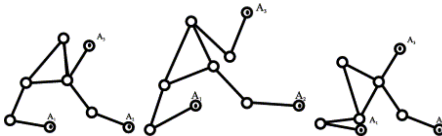
Figure 10 : Changement de mode d'assemblage pour un manipulateur parallèle 3-RRR
