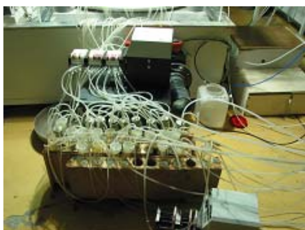
Photographie 1 : Pièges à soude contenant 200ml de NaOH 1M permettant de mesurer la respiration rhizosphérique. Il y a un piège à soude par pot.
