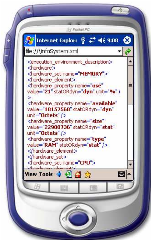
FIG. 3.19 – Exemple de fichier XML produit par le moniteur sur un Pocket PC sous Windows CE
