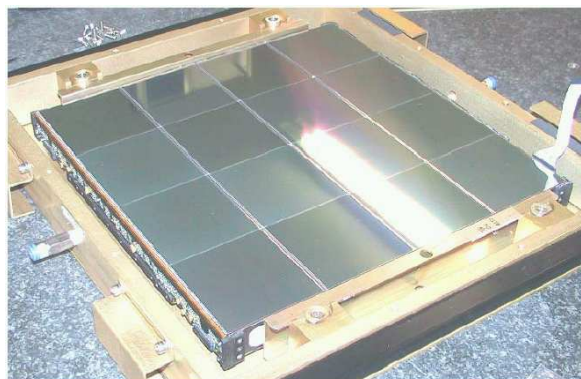
FIG. 6.4 – Echelles de Silicium en place dans leur cadre et déposées sur leur structure en fibres de Carbone, photographie extraite de [10].
