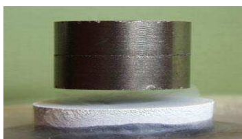
Aimant en lévitation au dessus d'un supraconducteur
