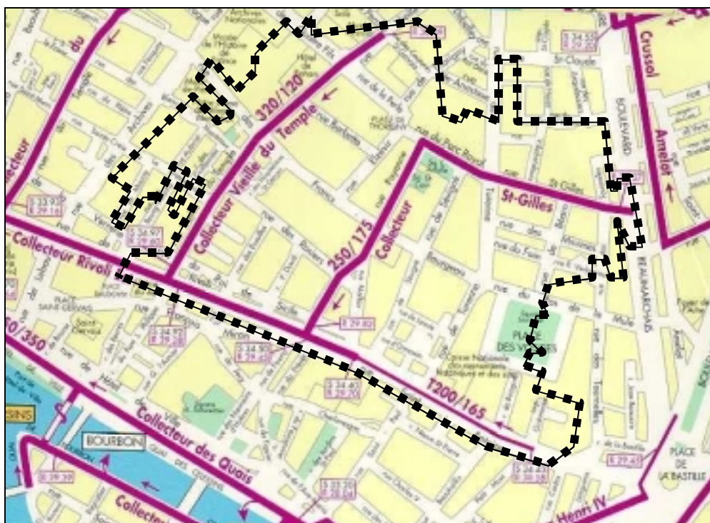
Figure III-11 - Bassin versant du Marais (contours en pointillé)
