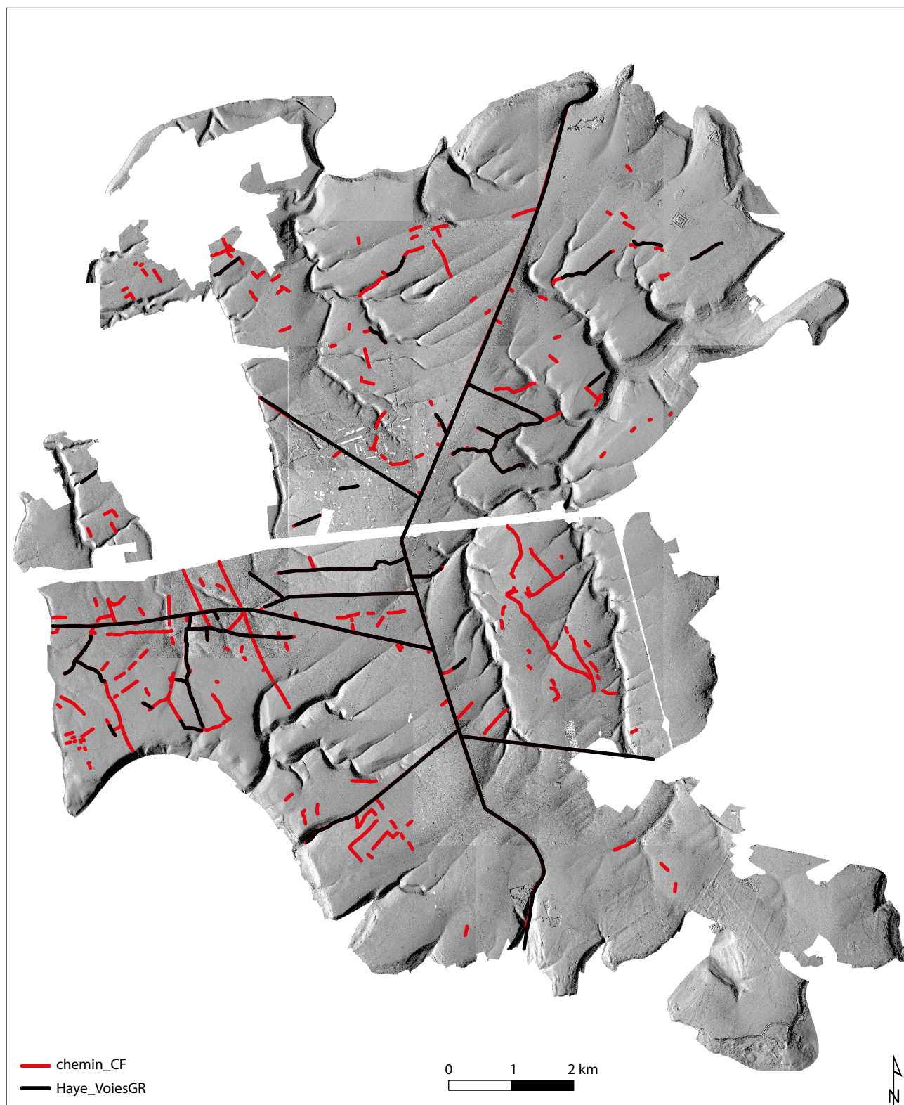
Fig. 17. Aperçu du réseau de chemins figuré sur le shapefile chemin_CF . Visualisation du MNT suivant un ombrage simple, azimut 315°, élévation 45° (C. Fruchart, Rurland 2017 ; données LiDAR Haye 2007, DRAC Lorraine, INRA Nancy, ONF).
